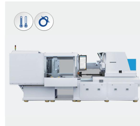
注塑机采用伺服电机进行开模、合模、注射和成型等机构，可提高响应性和稳定性。而由于设备的高温 and 振动，旋变器是角度传感器而不是光学传感器的最佳选择。
