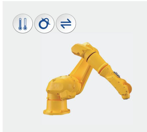
焊接机器人被用在有粉尘、高温、电噪声等严酷环境中。而旋变器是一种耐这种条件的传感器。
